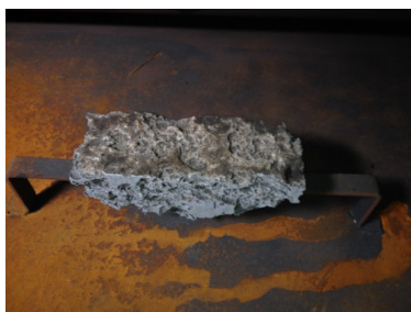
b 油罐底部牺牲阳极块的腐蚀形貌
