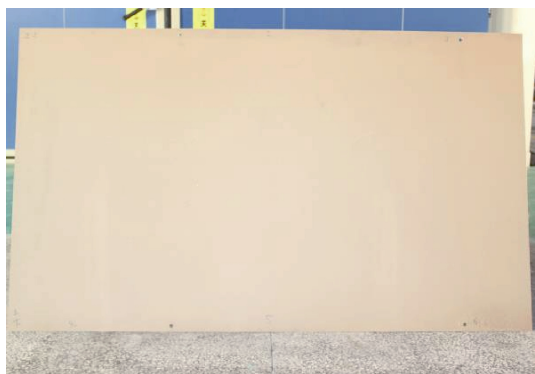
图8 微弧氧化后的钛合金大尺寸平板件
