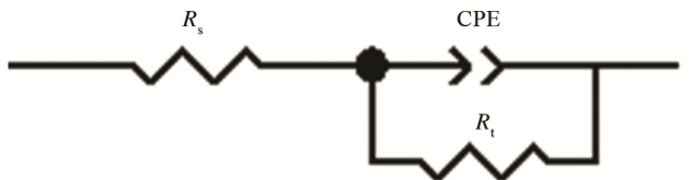
图 6 Q235 钢在添加 OFFE 的 0.5 mol/L 硫酸介质中的等效电路
