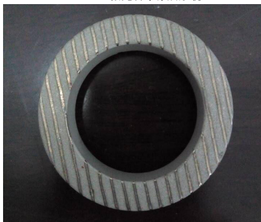
b 600 W 激光功率涂层形貌
