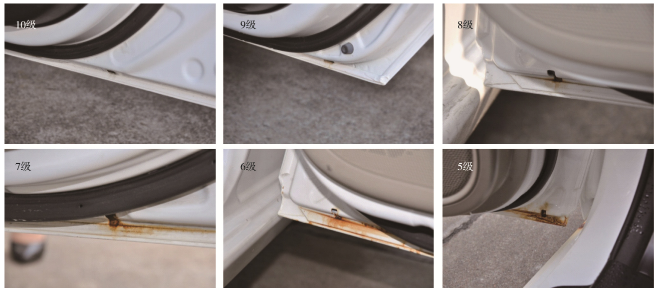
图 2 针对各零部件定义不同的腐蚀判断 Fig.2 Corrosion levels of components
