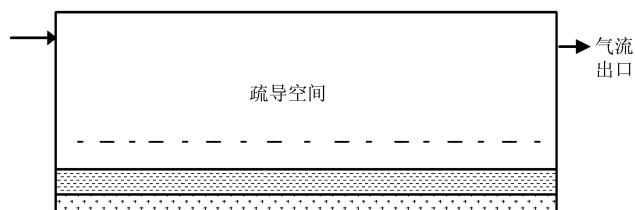
图 1 疏导式热控结构示意图
