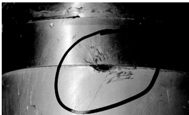
图 3 回收弹底接触端面烧蚀出孔洞
