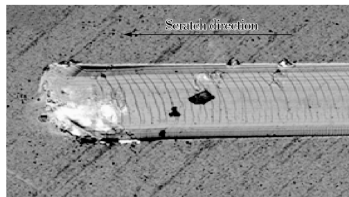
b 基体渗氮后沉积DLC薄膜
