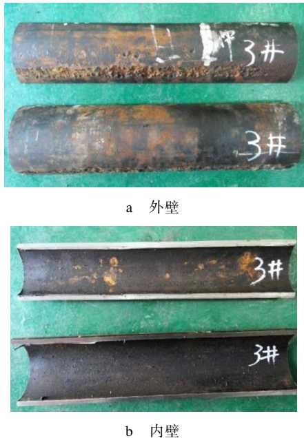
图 3 3#旁路管腐蚀情况
