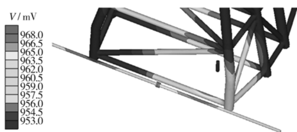
图3 海底管道模型表面保护电位分布云图
