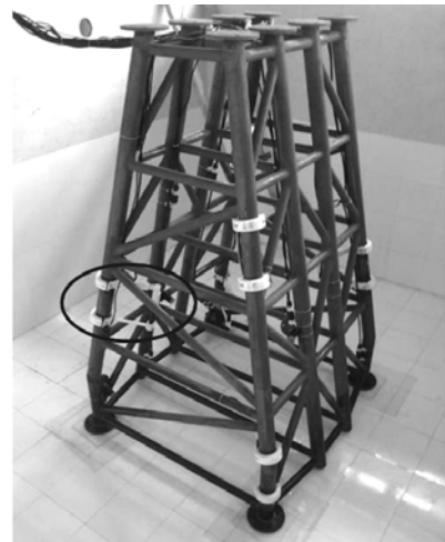
图 1 导管架平台模型及其外加电流阴极保护系统 Fig.1 Jacket platform model and ICCP system
