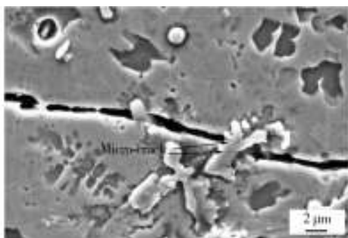
图4 激光熔覆层中的裂纹形貌
