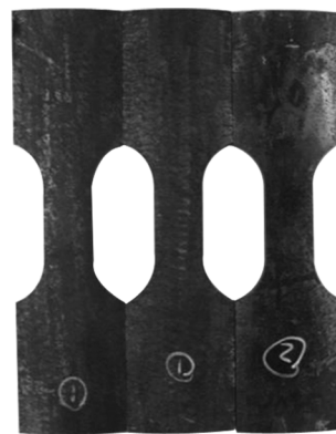
图5 拉伸试样试验前的宏观形貌
