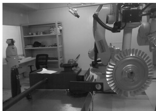
图3 航空发动机整体叶盘激光冲击强化设备
