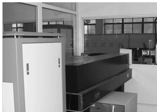
图2 叶片激光冲击强化装置
