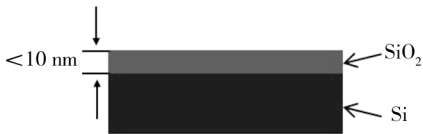
图 5 二氧化硅薄膜示意 Fig. 5 Diagram of silicon dioxide film
