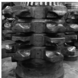
图 3 链轮的磨损
