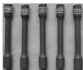
图 9 微弧氧化+喷漆 Fig. 9 Micro-arc oxidation + spray paint
