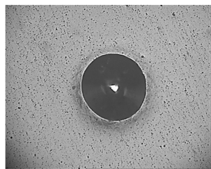
图 2 CrN 镀层结合强度的压坑形貌
