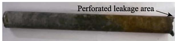
图 1 表面蒸发式空冷器失效管
