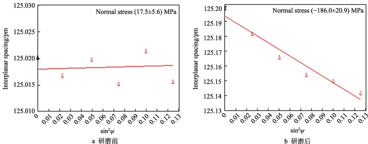
图11 焊缝表面研磨前后残余应力
