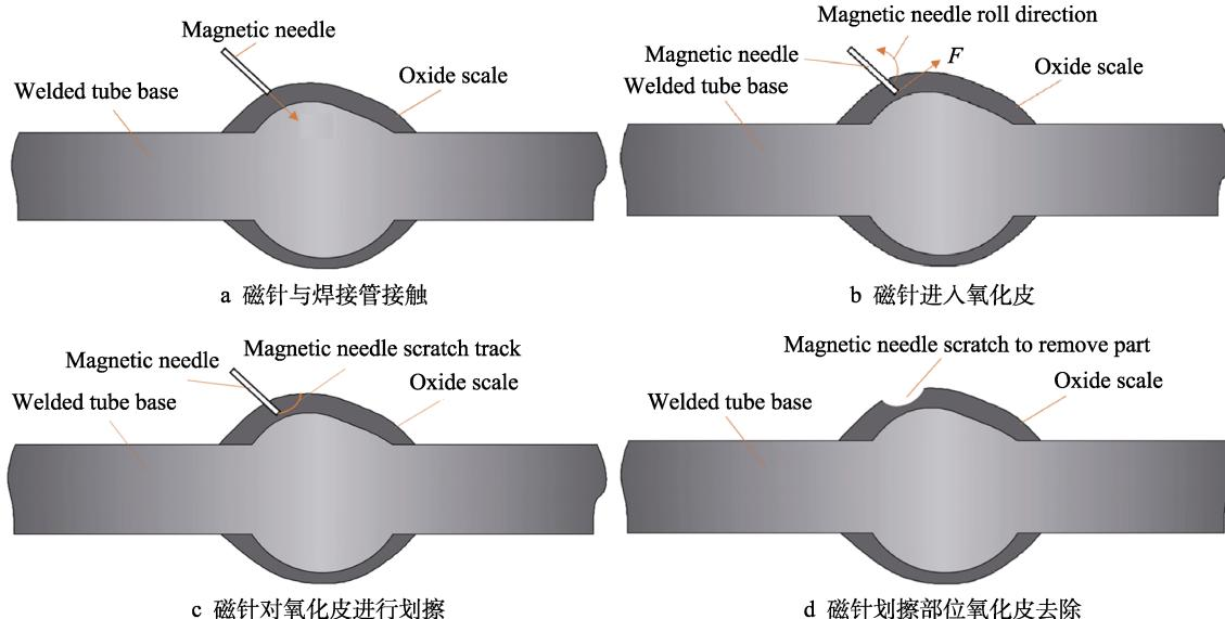
图 5 磁针去除氧化皮示意图
