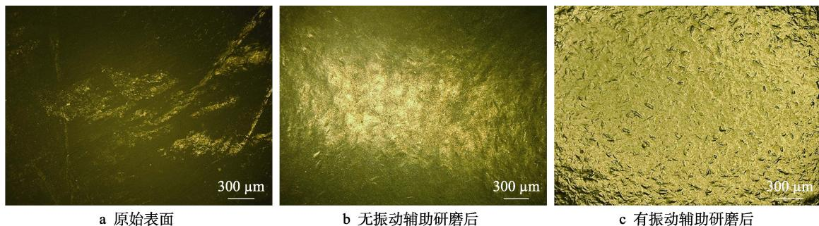
图8 有无振动辅助研磨的表面形貌对比
