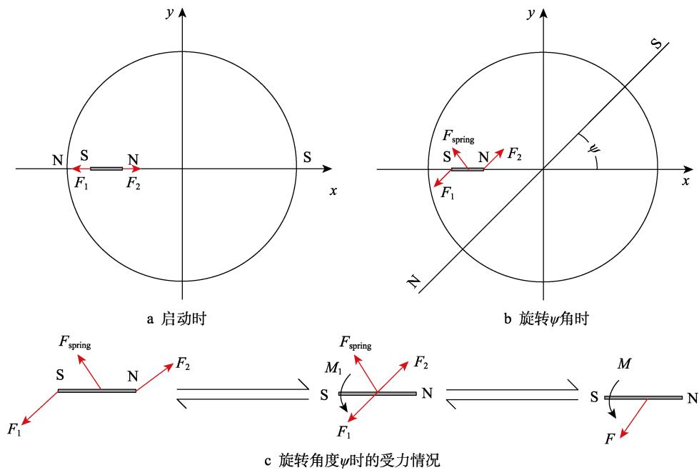
图4 单个磁针在旋转磁场中受力分析
