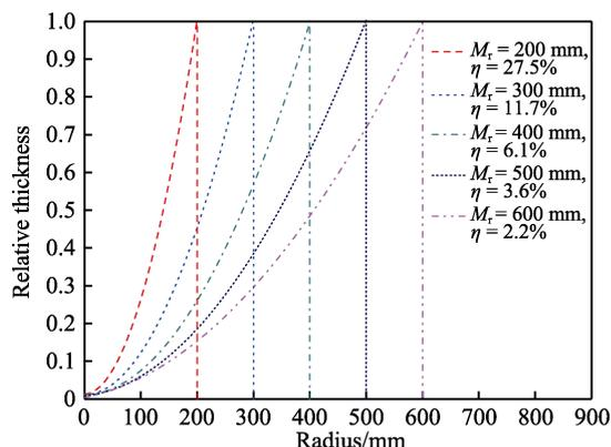
图8 修正挡板的形变量 $\eta$ 与膜厚均匀性的关系
