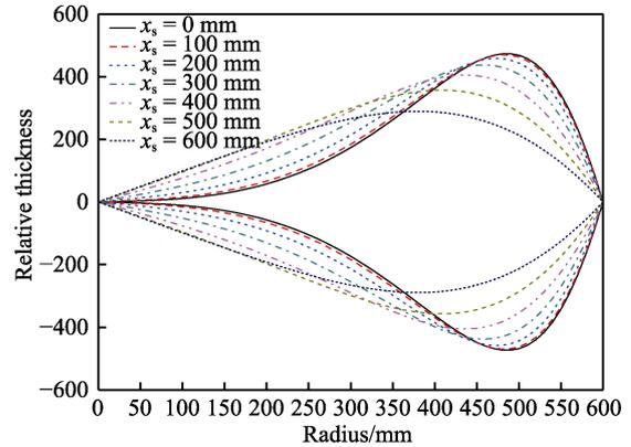
图 5 双蒸发源相位置参数  $x_s$  对修正挡板形状结构的影响 ( $M_f=600$  mm,  $k=-1$ ,  $R=2\ 000$  mm)
