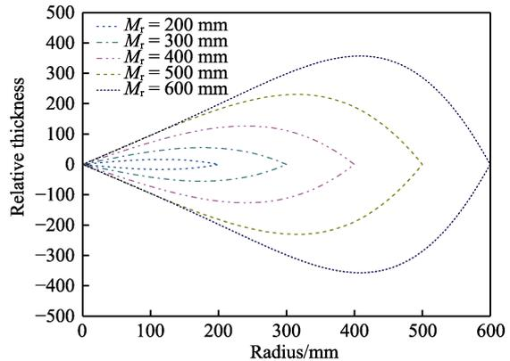
图 6 光学望远镜镜片半径  $M_f$  与修正挡板形状的关系 ( $k=-1$ ,  $R=2\ 000$  mm)
