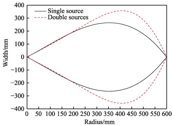
图 4 单蒸发源与双蒸发源所对应的修正挡板形状 ( $M_f=600$  mm,  $x_s=500$  mm,  $k=-1$ ,  $R=2\ 000$  mm)
