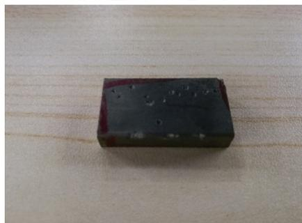
c 未镀镍阿基米德螺旋线局部腐蚀图
