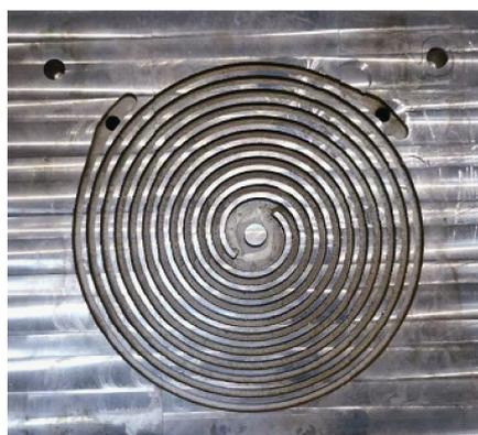
a 未镀镍发生腐蚀的阿基米德螺旋线
