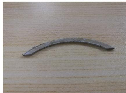
d 未镀镍阿基米德螺旋线隔板腐蚀图
