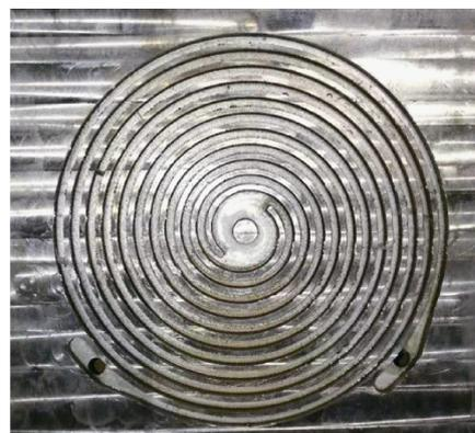
b 镀镍未发生腐蚀的阿基米德螺旋线
