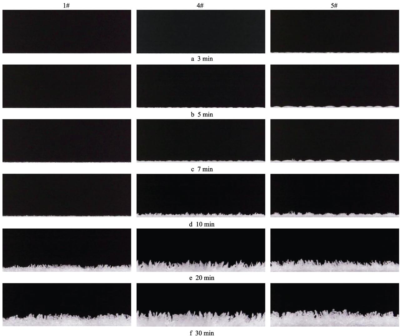
图3 三种表面在冷面温度为-5 °C时的结霜对比
