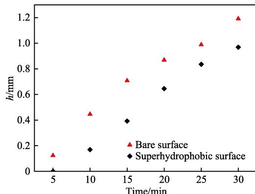
图7 冷面温度为-10 °C时两种表面的霜高对比
