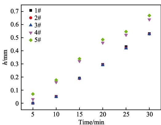
图4 冷面温度为-5 °C时不同表面的霜高对比
