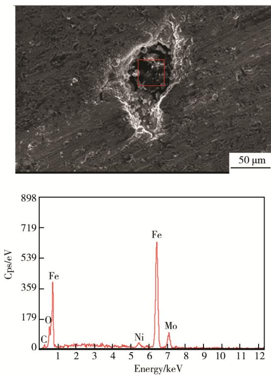
图10 单个微孔的磨损形貌及能谱分析图
