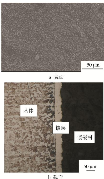
图5 复合镀层的显微形貌
