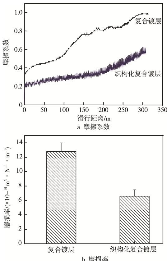
图 8 织构化复合镀层与未织构化镀层的摩擦性能对比
