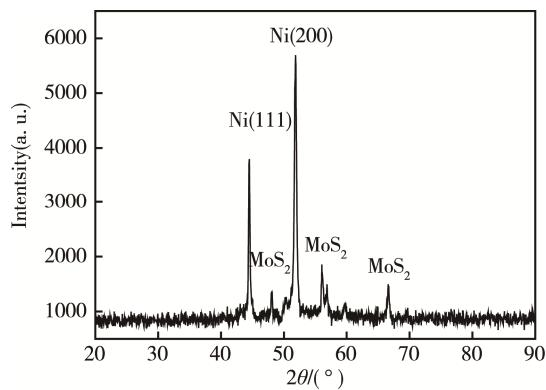
图6 复合镀层的X射线衍射图谱
