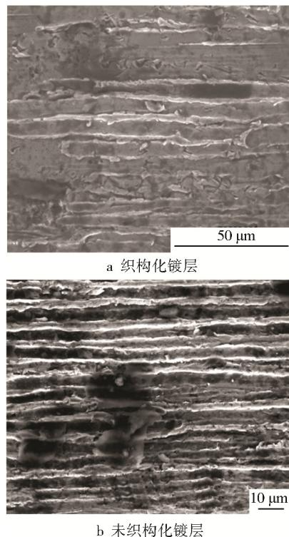
图 9 活塞环与缸套对磨后的磨痕形貌
