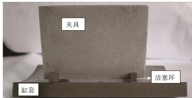
图 3 活塞环/缸套的安装图
