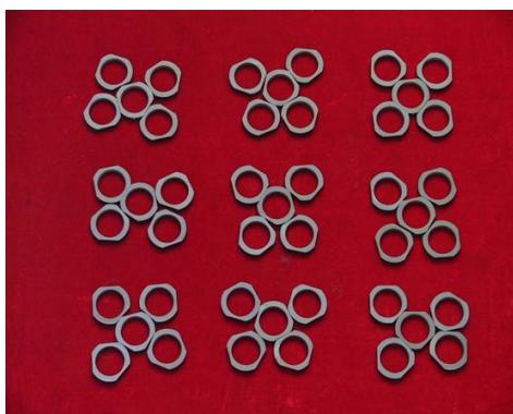
图 7 光学仪器走位零部件耐磨自润滑涂层效果
