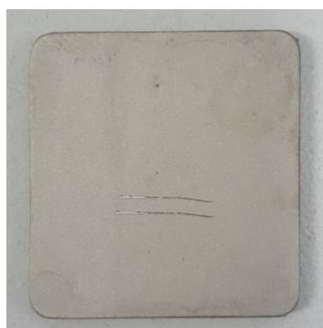
图8 氧化铝陶瓷化学镀镍层表面划痕的宏观形貌
