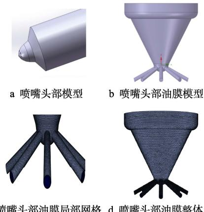
图2 喷油器喷嘴头部模型、油膜模型及网格
