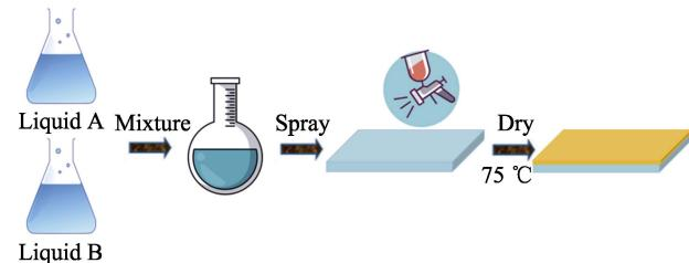
图 1 构建特殊浸润性表面的装置流程图
