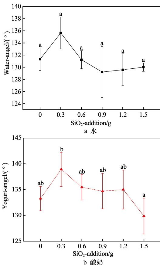
图 4  $\text{SiO}_2$  的添加量对特殊浸润性表面水和酸奶的接触角大小的影响 (相同的小写字母代表  $\text{SiO}_2$  添加量对特殊浸润性表面无显著性影响)
