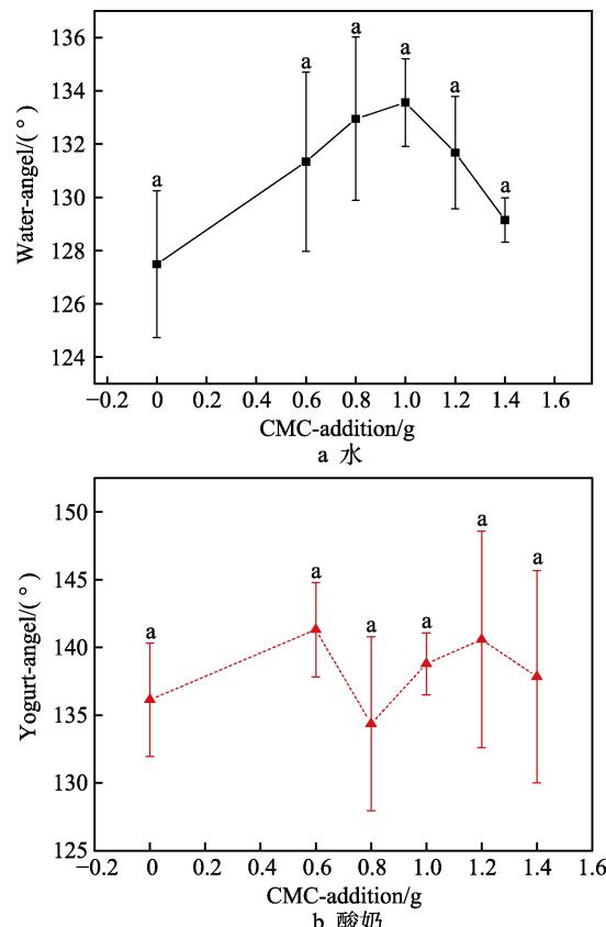
图 5 CMC-Na 添加量对特殊浸润性表面水和酸奶的接触角大小的影响 (相同的小写字母代表 CMC-Na 添加量对特殊浸润性表面无显著性影响)
