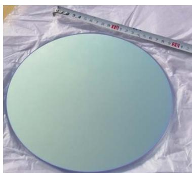
图 3 宽波段高反薄膜样品
