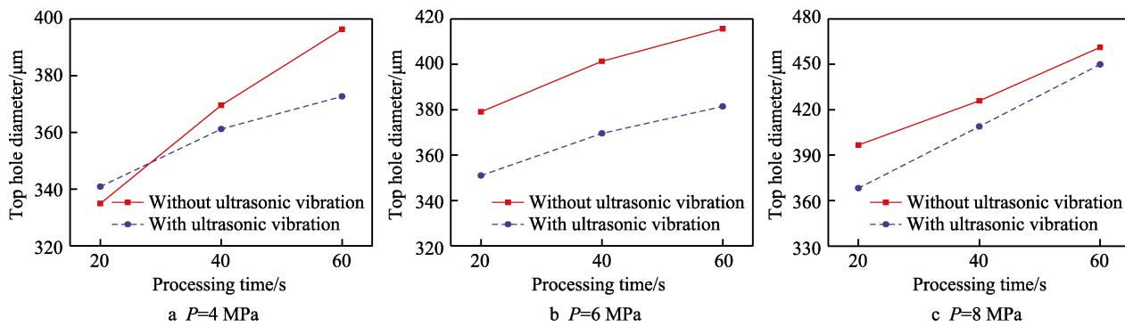
图 8 微孔顶部直径对比
