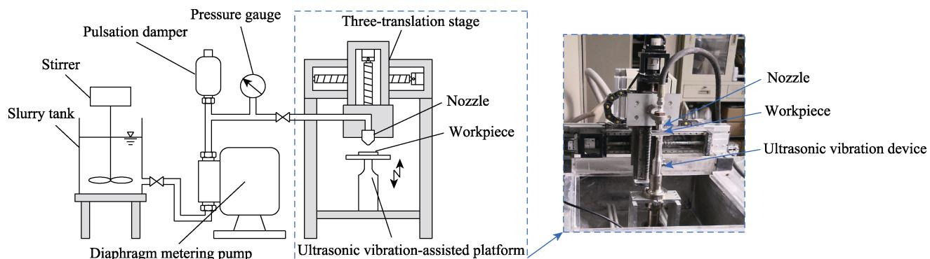
图 3 超声辅助微细磨料水射流加工装置<sup>[24]</sup>
