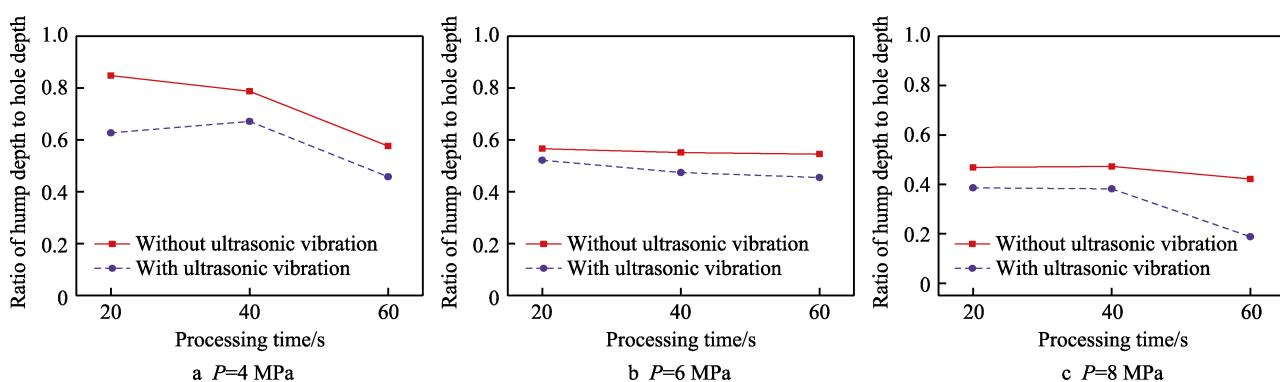
图 9 微孔底面平坦程度对比
