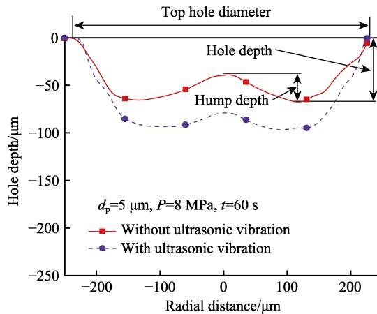
图 6 微孔主要测量尺寸
