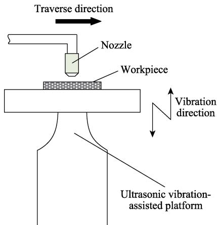
图 1 超声辅助微细磨料水射流加工示意
