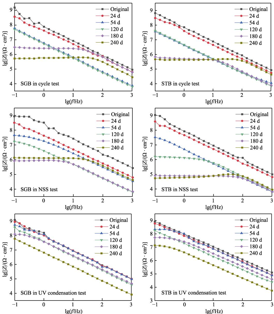
图 2 两种涂层体系在各加速老化试验条件下的 Bode 图
