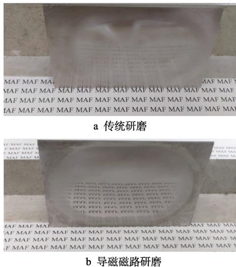
图 8 不同磁路加工研磨前后质量对比图
