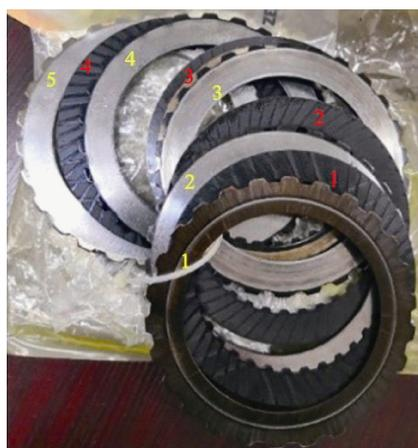
图 1 某湿式 DCT 摩擦副实物
