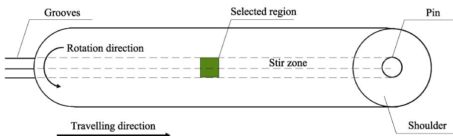
图 2 搅拌摩擦加工示意图
