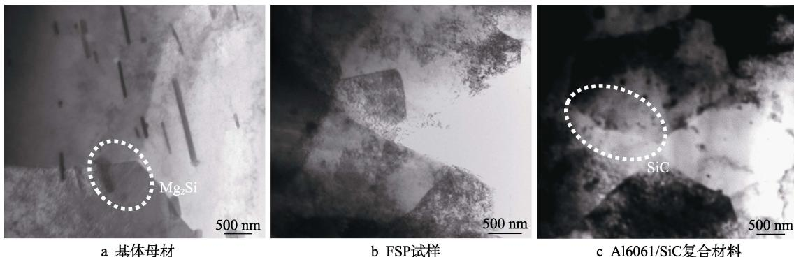
图 7 3 种试样的透射电镜照片
