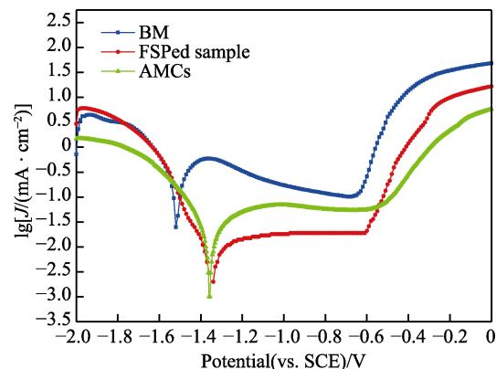
图 5 3 种试样的动电位极化曲线
