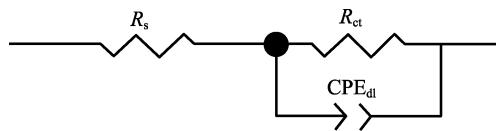
图 4 电化学阻抗谱拟合等效电路
