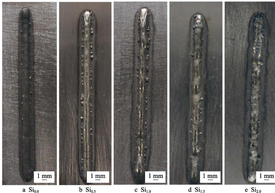
图 1 单道 CoCrFeNiSi<sub>x</sub> 高熵合金熔覆层的宏观形貌
