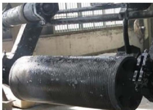
图 2 热浸镀 Zn 沉没辊表面结渣整体图<sup>[9]</sup>
