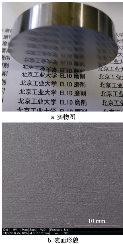
图 6 ZGMn<sub>13</sub>Cr<sub>2</sub>高锰钢实物图及 SEM 表面形貌
