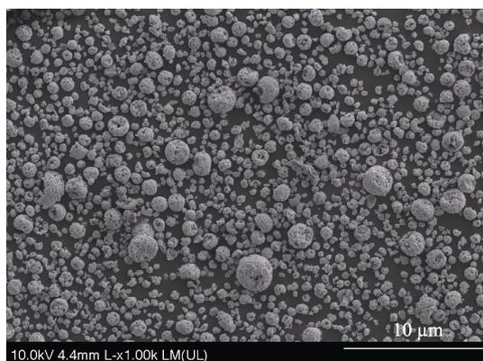
图 1  $\text{ZrO}_2\text{-7Y}_2\text{O}_3$  粉末微观形貌
