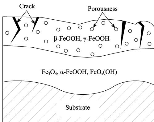
图 1 耐候钢表面锈层结构<sup>[16-19]</sup>
