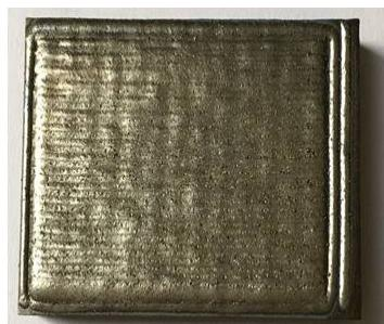
图 3 激光熔覆表面
