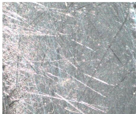
图 7 研磨前的微观形态
