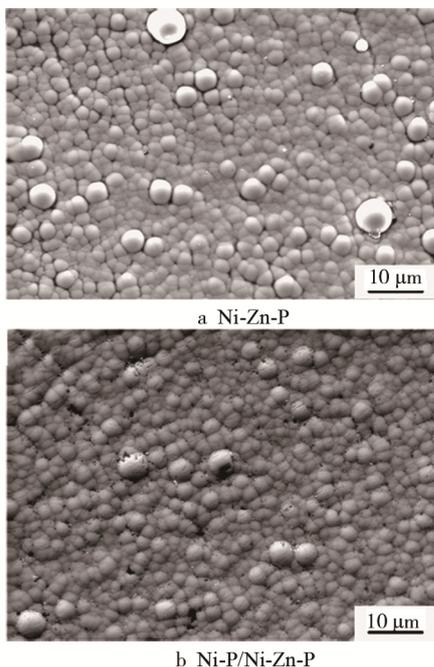
图1 Ni-Zn-P合金镀层和Ni-P/Ni-Zn-P双层复合镀层的SEM图
