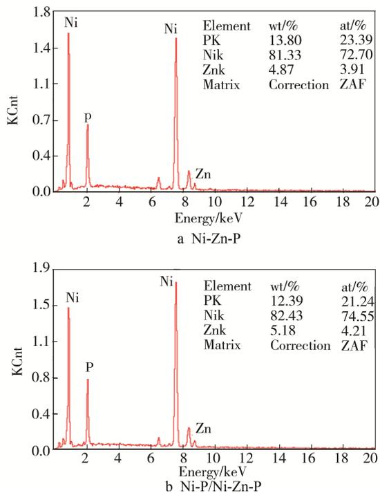
图2 Ni-Zn-P合金镀层和Ni-P/Ni-Zn-P双层复合镀层EDS图
