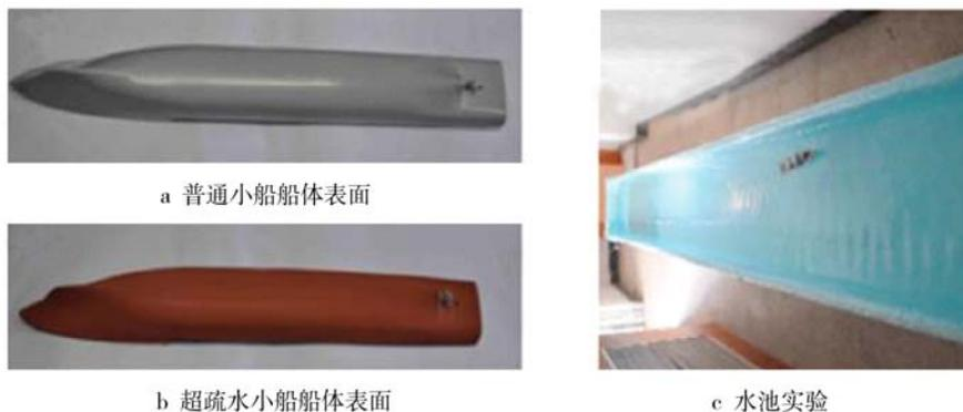
图 10 小船模型及水池实验
