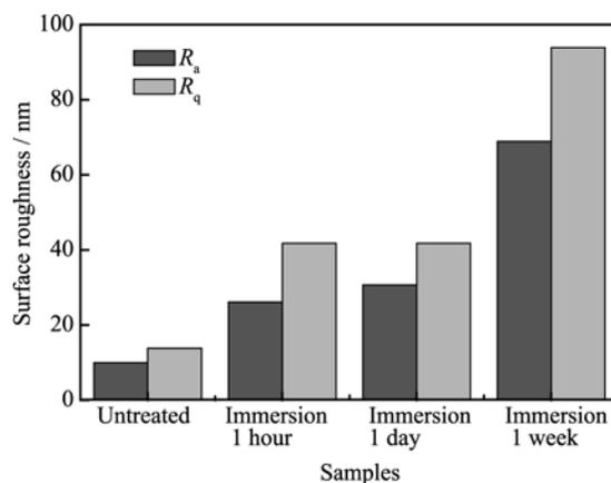
图 1 316L 不锈钢在模拟体液中不同浸泡时间的表面粗糙度
