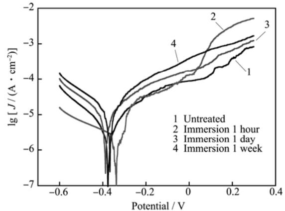
图 4 316L 不锈钢在模拟体液中浸泡不同时间的极化曲线
