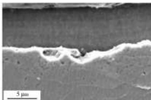
图3 电镀层 SEM 照片(5000×)
