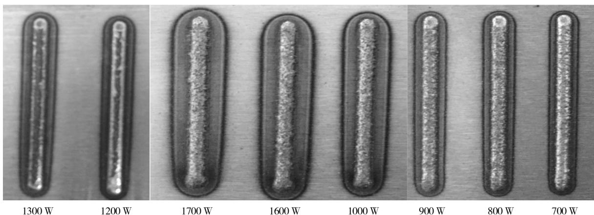
图1 不同激光功率下所得熔覆层的形貌
