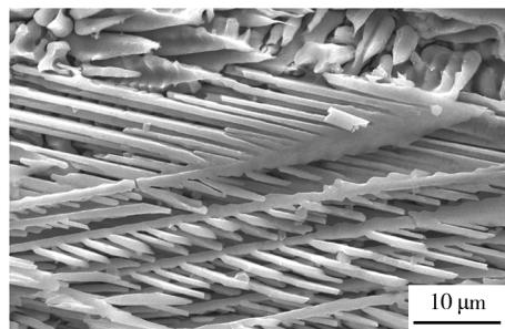
图3 树枝晶 $\sigma$ 相的形貌
