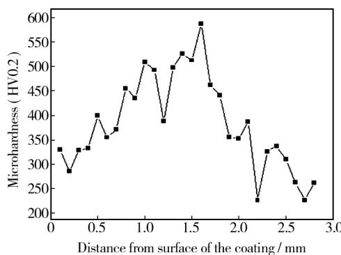
图4 涂层的显微硬度分布
