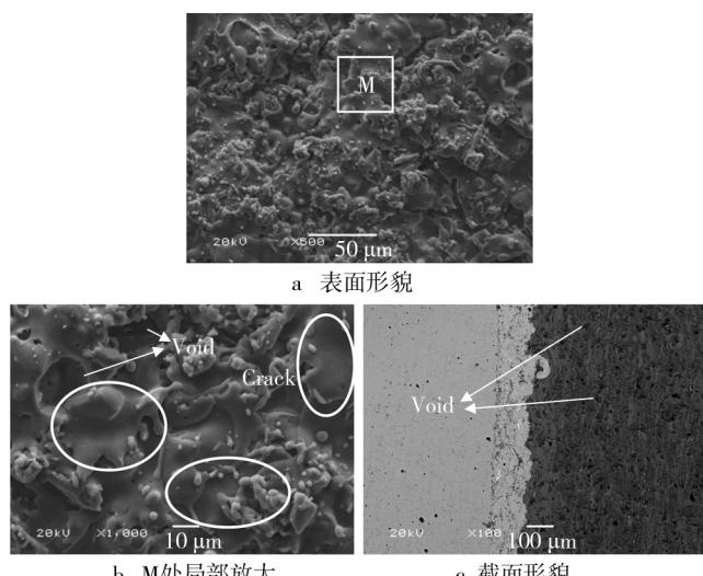
图 4 微米 Al<sub>2</sub>O<sub>3</sub> 涂层微观形貌(SEM)
