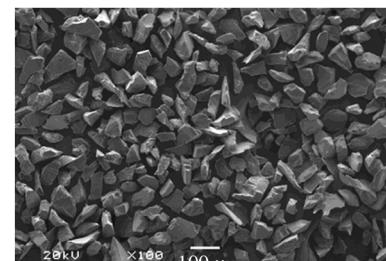
图 3 微米 Al<sub>2</sub>O<sub>3</sub> 粉末 SEM 照片
