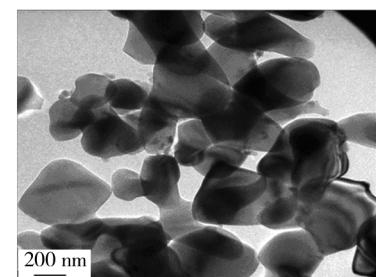
图 1 纳米 Al<sub>2</sub>O<sub>3</sub> 粉末 TEM 照片
