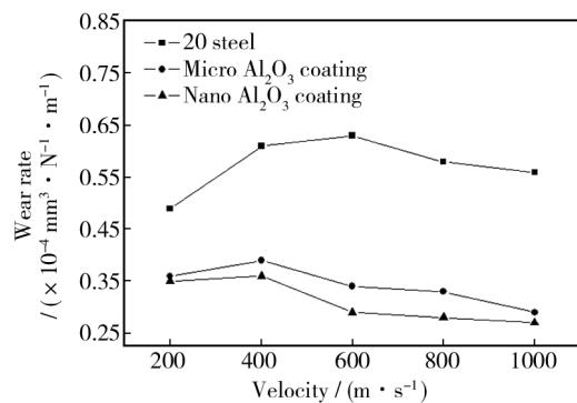
图 7 不同转速下  $\text{Al}_2\text{O}_3$  涂层与 20 钢基体的磨损率
