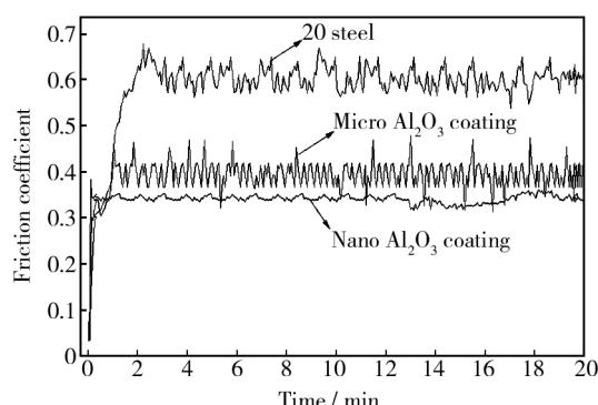
图 6 涂层与 20 钢基体的摩擦系数随时间的变化
