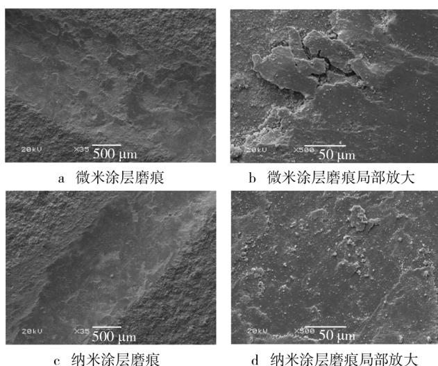
图 8  $\text{Al}_2\text{O}_3$  涂层磨损形貌
