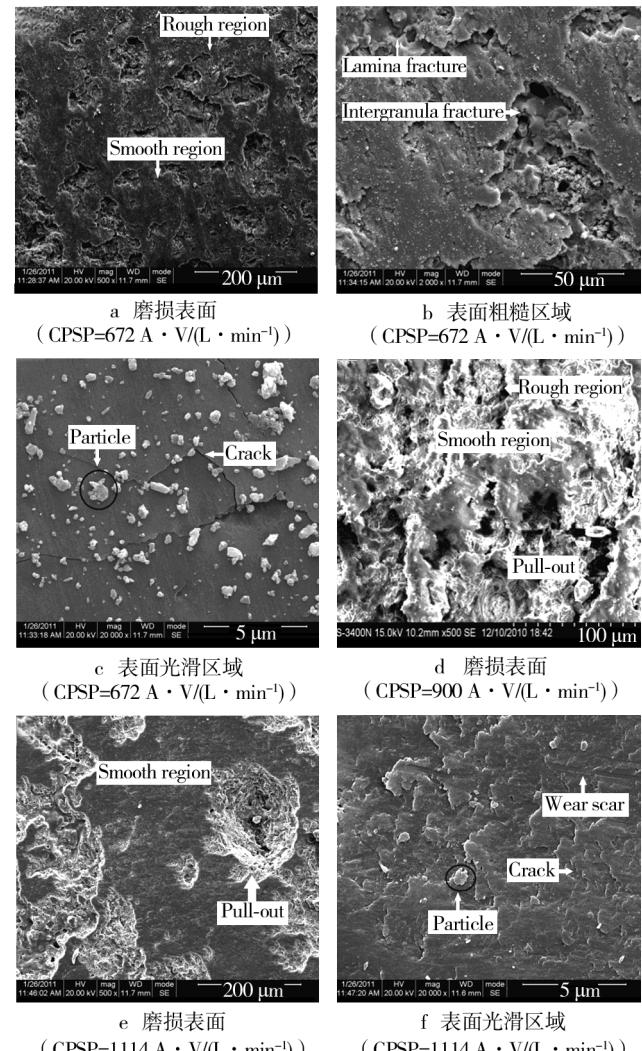
图5 不同CPSP条件下所制备涂层的室温磨损表面
