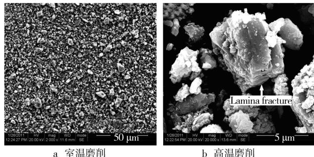
图7 涂层磨屑形貌( $\text{CPSP}=900 \text{ A} \cdot \text{V}/(\text{L} \cdot \text{min}^{-1})$ )
