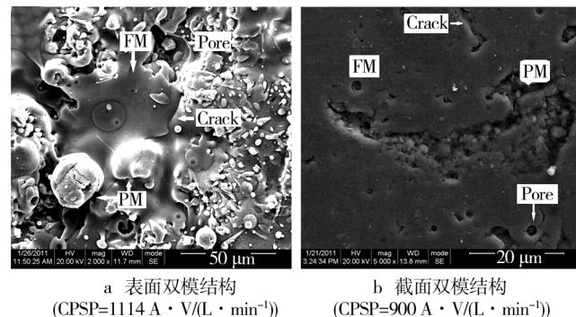
图 3 纳米  $\text{Al}_2\text{O}_3$ -13%  $\text{TiO}_2$  涂层形貌
