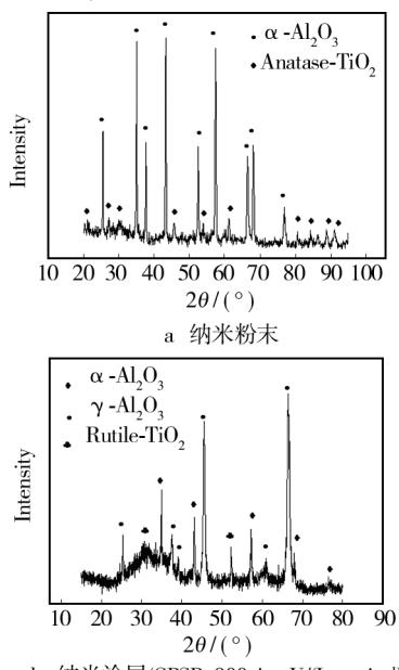
图 2 纳米  $\text{Al}_2\text{O}_3$ -13%  $\text{TiO}_2$  粉末和涂层的 XRD 衍射结果
