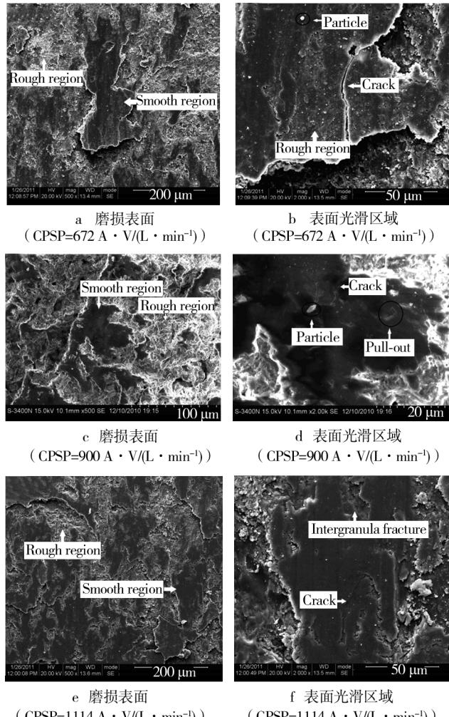
图6 不同CPSP条件下所制备涂层的高温磨损表面
