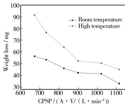
图4 室温和高温下纳米  $\text{Al}_2\text{O}_3$ -13%  $\text{TiO}_2$  涂层磨损失重数据及其与CPSP的关系
