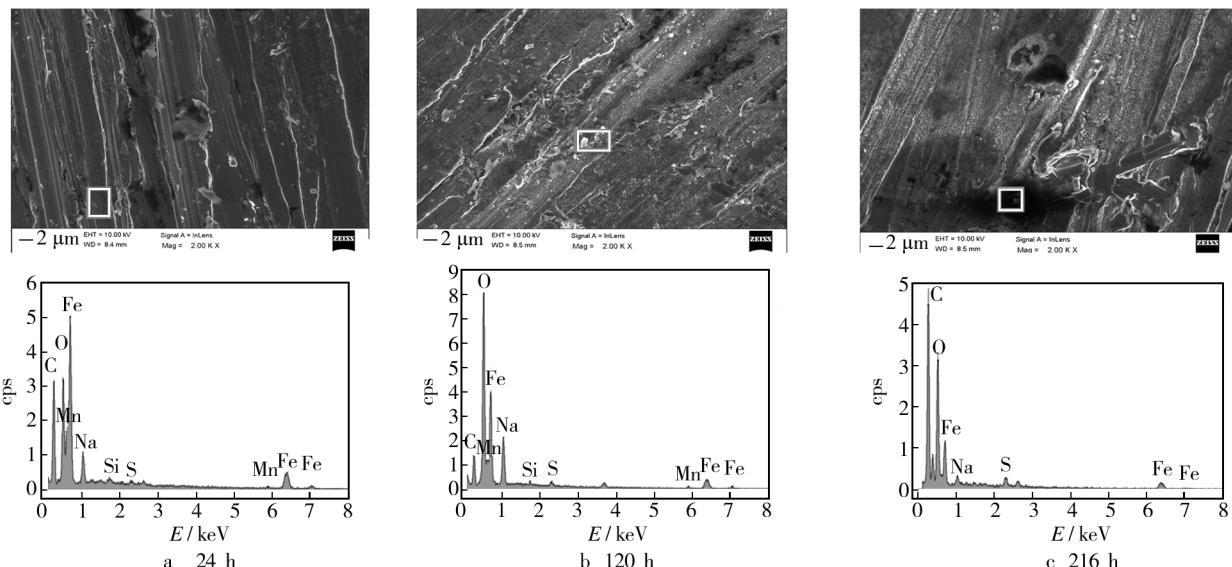
图2 不同取样时间的试样微观形貌及EDS分析
