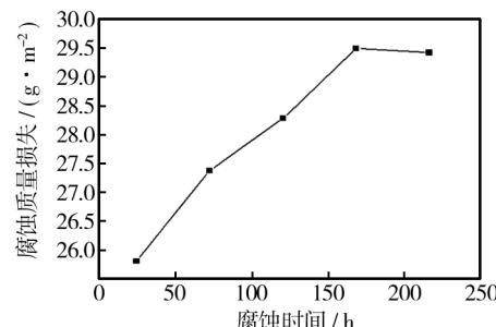
图3 16Mn不同取样时间的腐蚀质量变化
