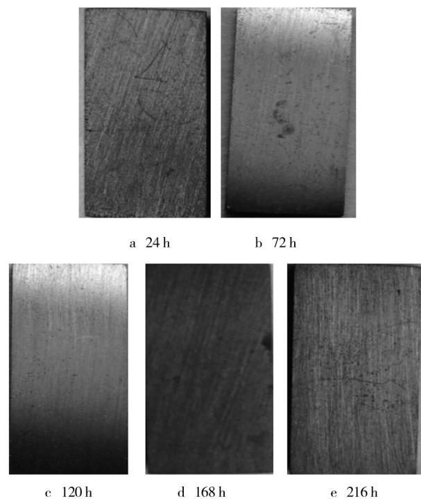
图 1 不同腐蚀时间下的试样宏观形貌对比
