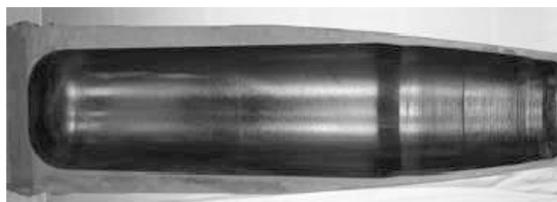
图 5 弹药内表面漆膜照片
